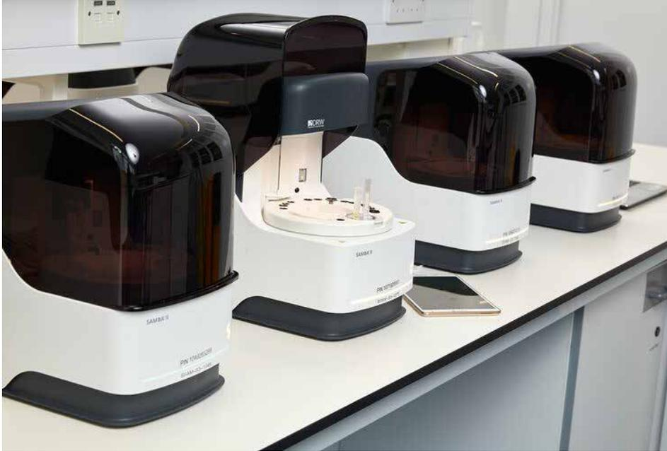
Le SAMBA II est environ de la taille d'une machine à café et convertit la détection d'un acide nucléique en un simple signal visuel comme pour un test de grossesse. Il est livré avec des cartouches présentées en dose unitaire (contenant quelque 180 produits chimiques et réactifs nécessaires) qui sont simplement insérées dans la machine. Celle-ci fonctionne selon le principe "prélèvement de l'échantillon – communication des résultats" – et est censée être infaillible.
