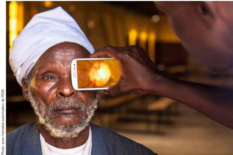
Le Kit d'examen ophtalmologique portable (PEEK) mis au point par Andrew Bastawrous et son équipe tire parti de la polyvalence et de la puissance des smartphones en associant une application et un dispositif adaptable sur la lentille de l'appareil photo pour créer une véritable clinique ophtalmologique portable. Exemple d'innovation frugale, ce kit permet aux patients vivant dans les communautés les plus isolées et démunies de bénéficier de soins ophtalmologiques abordables et de qualité.
