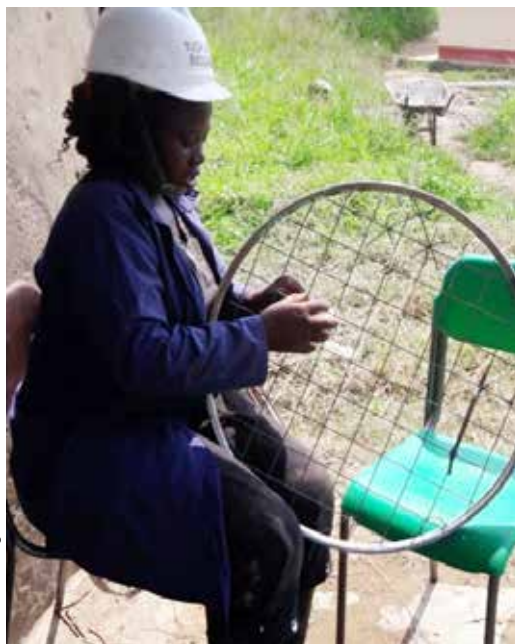
L'inventrice des toilettes sèches, Rachael Nabunya Kisakye, fabrique un regard pour la chambre de méthanisation.
