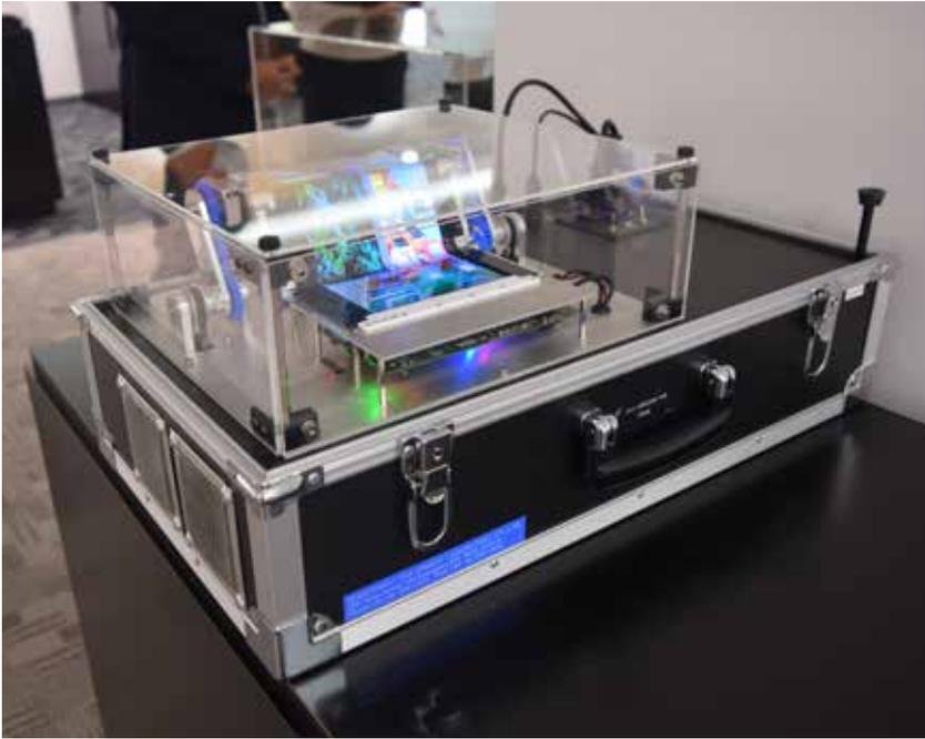
Una pantalla plegable de 8,67 pulgadas con un sensor táctil integrado. La pantalla puede resistir más de 100.000 pliegues.
