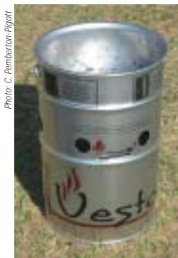
Le poêle Vesto, réalisé à partir d'un bidon à peinture de 25 litres. Des chambres de préchauffage font monter la température de l'air de combustion, d'où un meilleur rendement calorifique.
