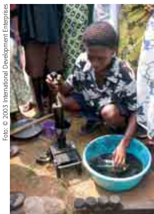
Mujer en el Mercado de Jukwa en Ghana fabricando briquetas de alta densidad con una prensa diseñada y fabricada por el D-Lab del MIT.
