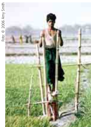
La bomba de pedal de bambú, diseñada por Gunnar Barnes e International Development Enterprises de Nepal se fabrica en talleres locales de Nepal y Bangladesh.
