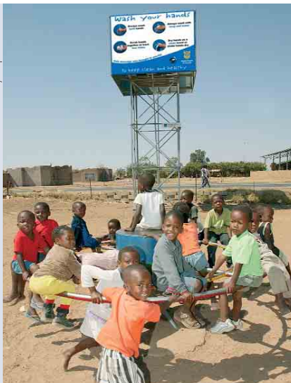
Con una hora de juego, se extraen unos 1.400 litros de agua. Las vallas publicitarias contienen mensajes sobre salud y generan ingresos publicitarios que permiten financiar el mantenimiento.
