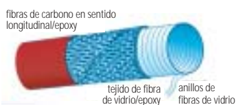
Sección transversal de una pértiga moderna
