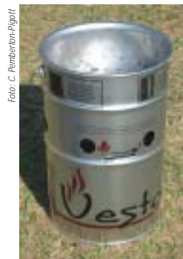
Hornillo Vesto, fabricado a partir de un bote de pintura de 25 litros. En las cámaras interiores del hornillo se calienta previamente el aire del exterior, mejorando su eficacia.
