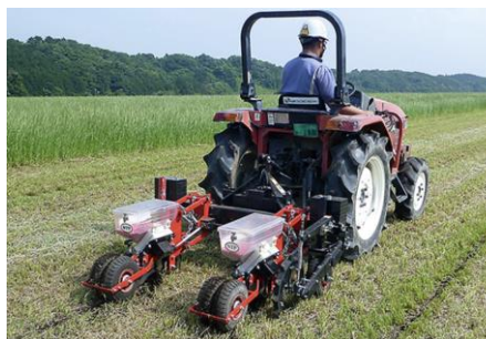
(左) 農研機構とアグリテクノ矢崎共同開発の不耕起対応トウモロコシ高速播種機_NTP-2 (画像: 農研機構)
