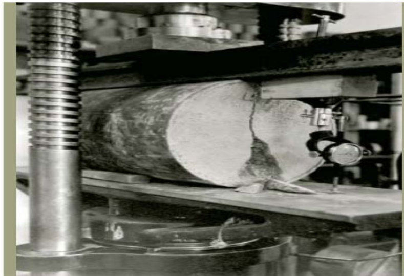
Brazilian Test - Ensaio de compressão diametral de um rolo de concreto, realizado pela Divisão de Materiais de Construção, década de 1940.
