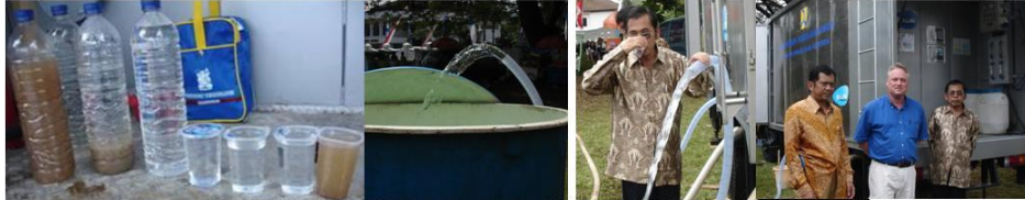
AIR BAKU AIR PROSES HYDRAULIC DAN HASIL PENGOLAHAN LENGKAP DARI 900 NTU MENJADTO NTU
